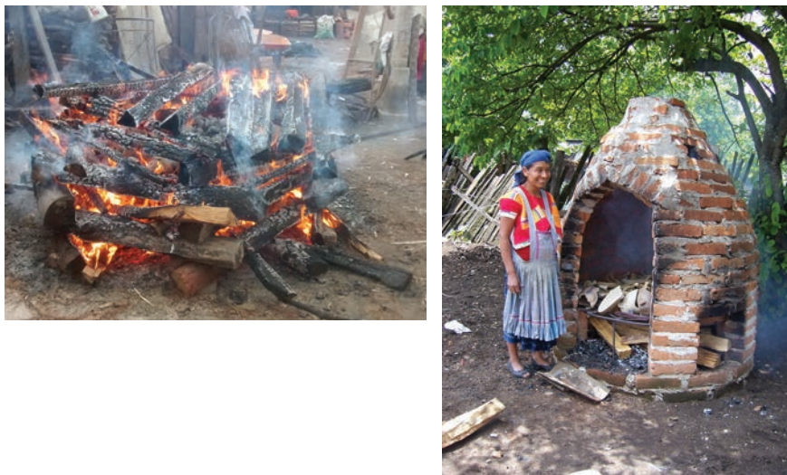
Figura 3. Quema de alfarería a cielo abierto y quema con horno de leña en Amatenango del Valle
