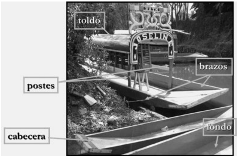
Figura 1. Partes principales de una canoa. Foto de Rodrigo Vega Sánchez, 2011.
