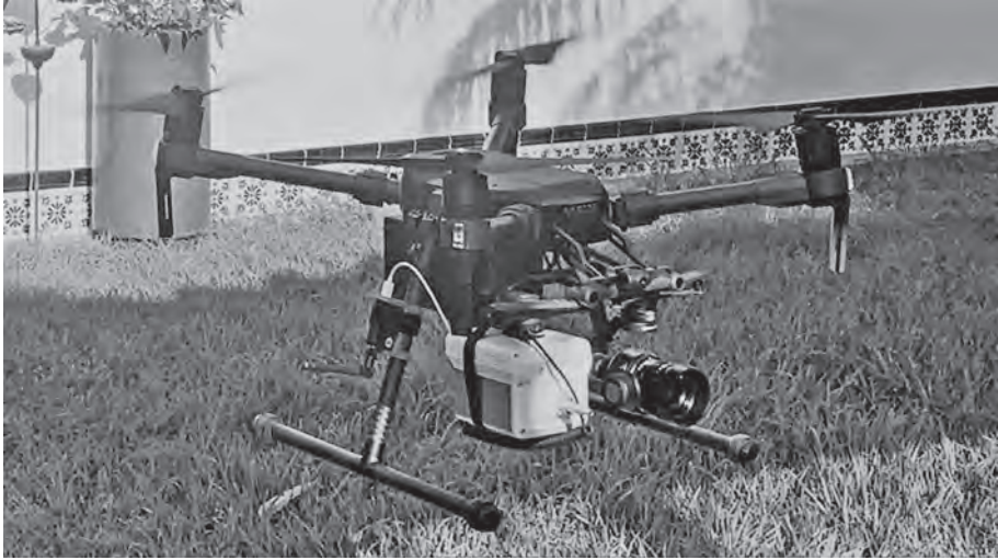
Figura 3 Sensor de gases empleado para la detección de gases contaminantes en el aire, montado en un dron DJI Matrice 210 V2, equipado con cámara RGB de alta resolución
