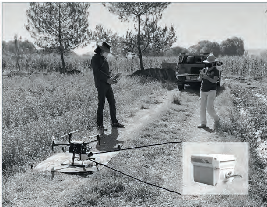
Figura 12 Dron DJI Matrice 210 V2, equipado con sensor de gases Sniffer V2, empleado para la detección de compuestos orgánicos volátiles en campos de cultivo en el periurbano de la ciudad de Morelia
