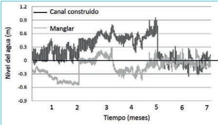
El valor de 0 corresponde al nivel del terreno de la zona de manglar donde se instaló en medidor de presión.
